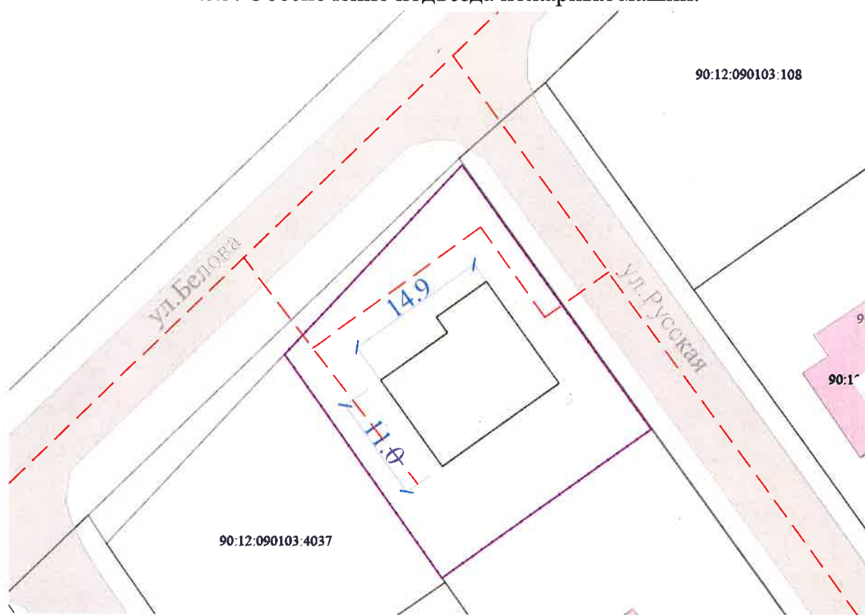
Рис.5. Обеспечение подъезда пожарных машин.
