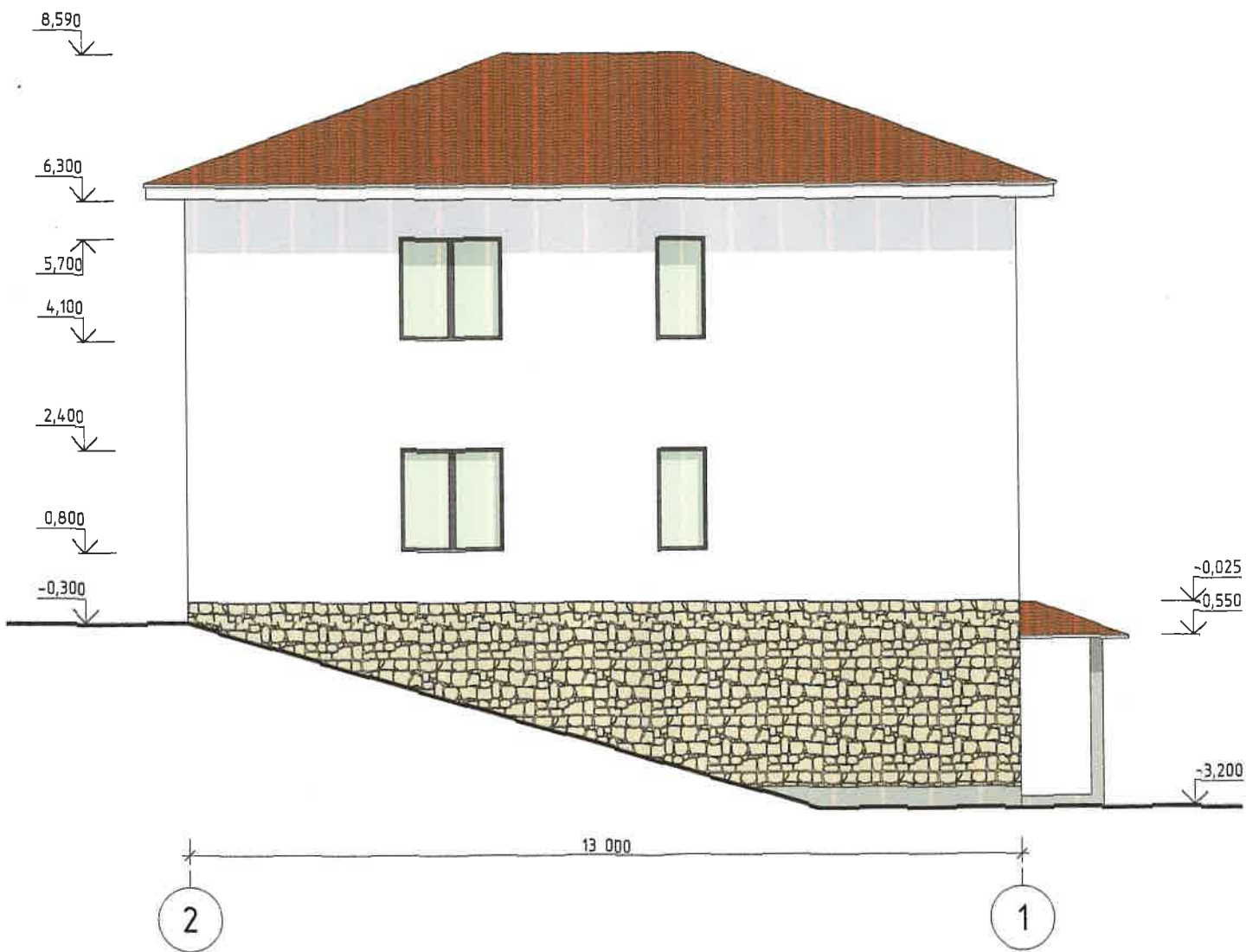
Фасад в осях 2-1
